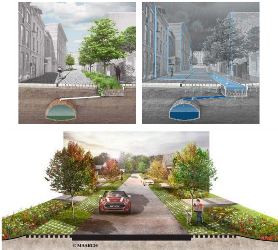
Figuur 36: Herinrichting van straten, met integratie van groenvoorzieningen en infiltratie, naar aanleiding van rioleringswerken: 1) binnen het verstedelijkt gebied (Leuven, bron: De Urbanisten) en 2) in straten met meer ruimte voor voorzieningen (Heusden-Zolder, bron: blauwgroenvlaanderen)
