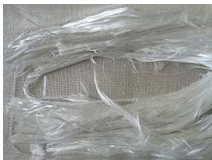
Chrysotiel asbest ( in volksmond witte asbest ) Wit, zacht, serpentijn vorm Gevaarlijk bij inademing
